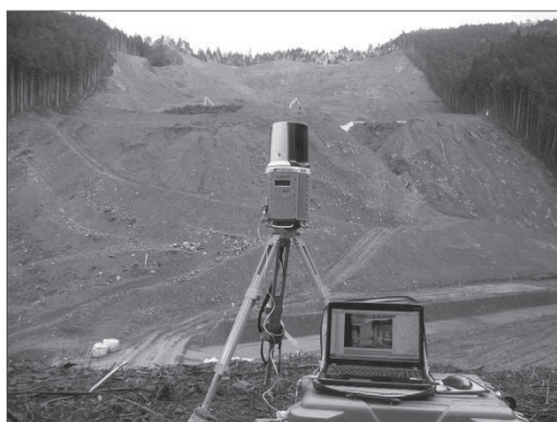
3D レーザー測量の様子
