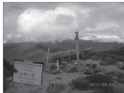
精密測地網基準点測量の様子
