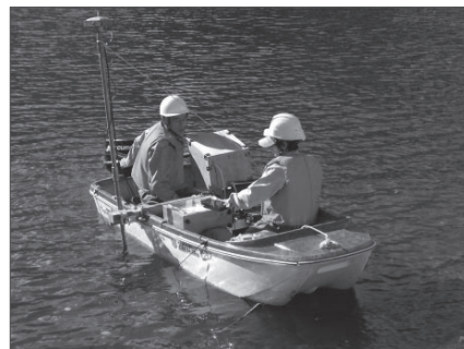
GNSS 深浅測量の様子
