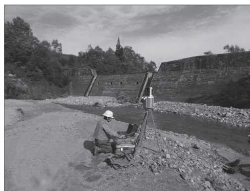
3D レーザー測量の様子
